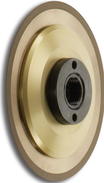
Diese Schlitzschleifscheibe mit Stahlgrundkörper ist speziell für das Schleifen tiefer Nuten geeignet. Im Vergleich zur Schleifscheibe 1A1R hat diese Scheibe am seitlichen Belag keinen Freiwinkel, d.h. auch wenn die Scheibe am Umfang abnimmt, bleibt die Breite immer konstant. Standardbohrung ist Ø31,75 mm oder gegen Aufpreis größer. Für Bohrungen unter 31,75 mm muss ein Reduzierflansch verwendet werden, in welchem die von Ihnen gewünschte Bohrung enthalten ist.
